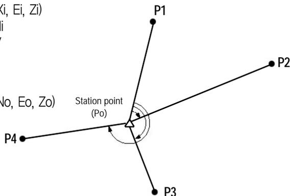
➔ SET에서는 2~10개의 기지점을 관측하여 기계점의 좌표를 산출합니다. 거리 측정이 가능한 경우는 적어도 2점이 필요하며 한 곳이라도 거리를 측정할 수 없는 포인트가 있을 때는 적어도 3점의 기지점 관측을 실행하여 산출할 수 있지만 기지점의 수가 많을수록 또는 거리 측정을 하는 포인트의 수가 많을수록 좌표치의 정도는 높아집니다.
