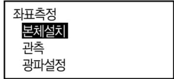
4. <좌표측정>에서 '관측'을 선택하십시오. [측정]을 누르면 측정이 시작되며, 타겟의 좌표값이 표시될 것입니다. 측정을 멈추려면 [정지]를 누르세요.
