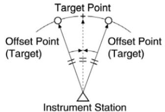
1. 옵셋 포인트의 타겟을 시준하고, 측정 모드 화면에서 [측정]을 누릅니다. '관측 시작 화면'이 표시됩니다.
